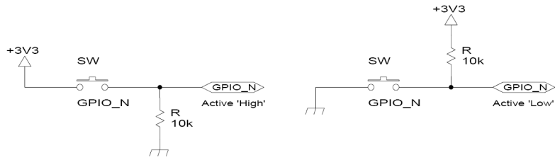
그림 5-5 GPIO 스위치 입력
