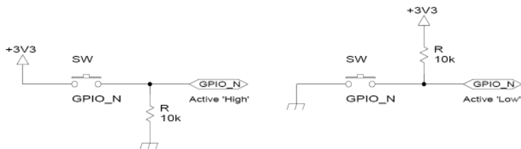
그림 5-5 GPIO 스위치 입력
