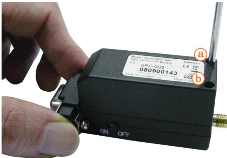
그림 2-7 배터리 팩 고정
