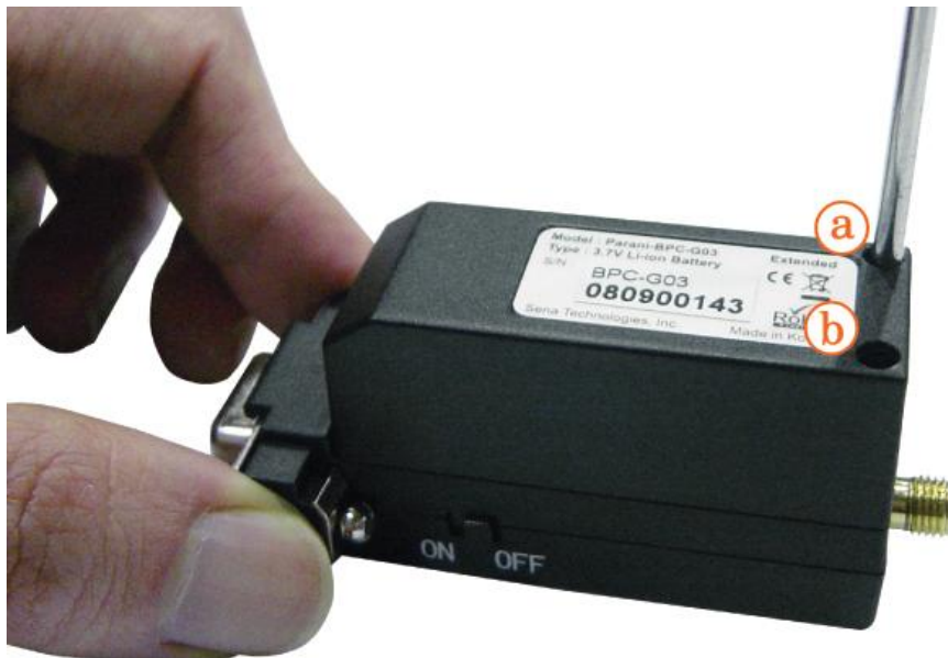
그림 2-7 배터리 팩 고정
