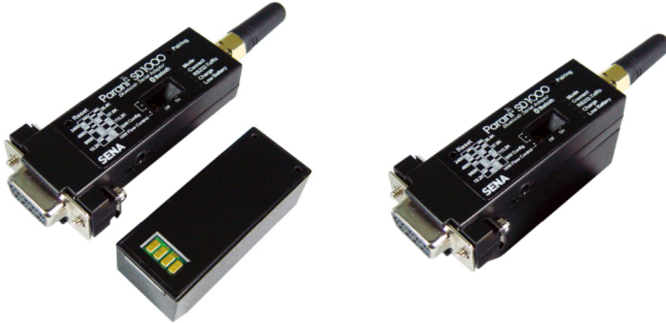
그림 2-4 SD1000에 배터리 팩 연결
