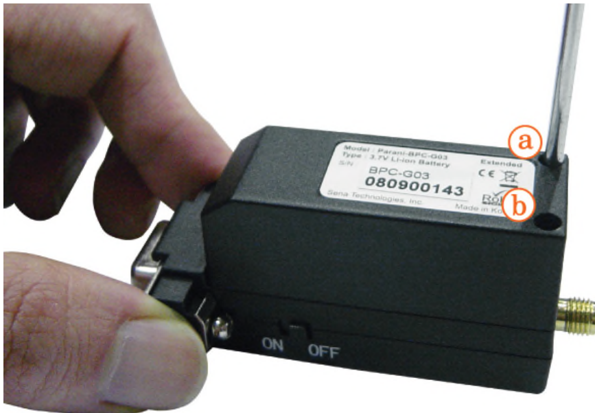
그림 2-7 배터리 팩 고정
