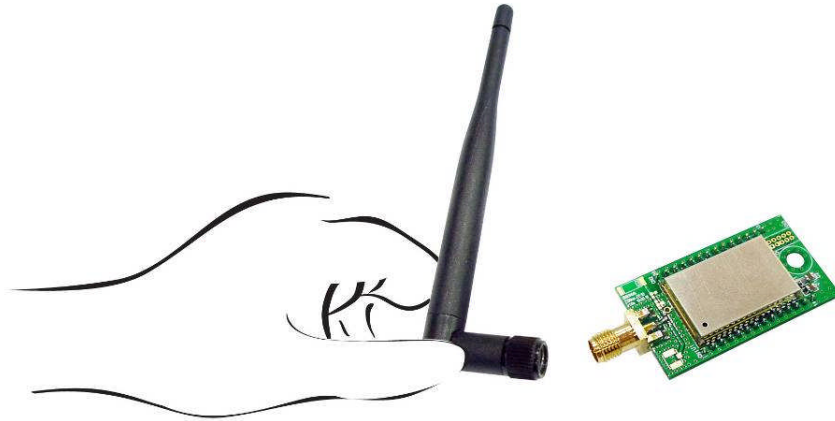
그림 2-2 RP-SMA 다이플 안테나 설치
