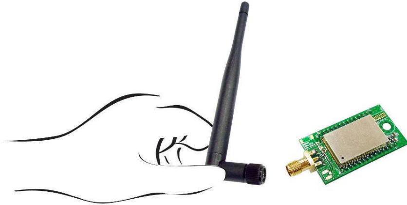
그림 2-2 RP-SMA 다이폴 안테나 설치
