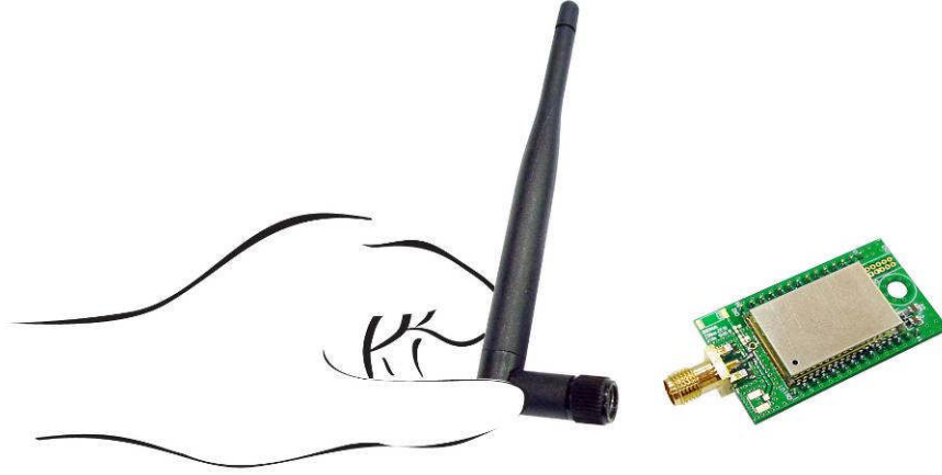
그림 2-2 RP-SMA 다이폴 안테나 설치
