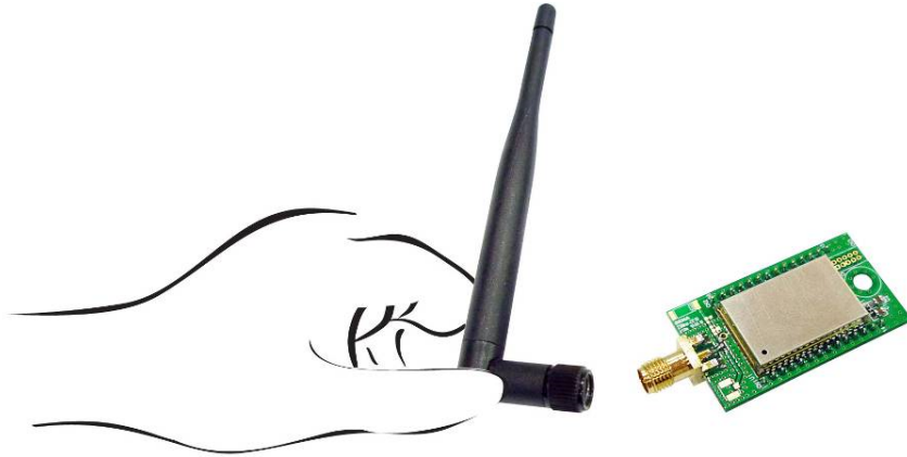
그림 2-2 RP-SMA 다이폴 안테나 설치
