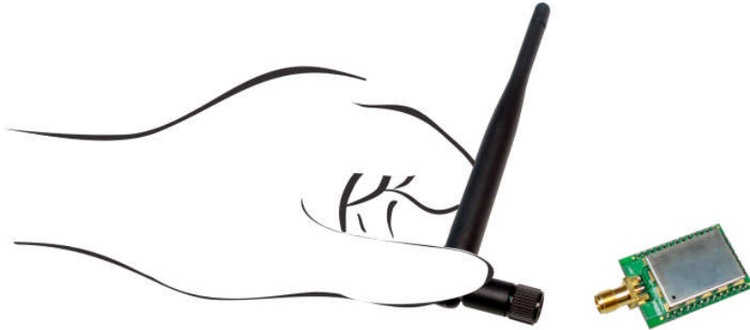
그림 2-2 RP-SMA 다이폴 안테나 설치
