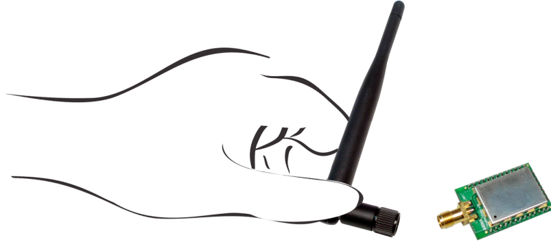
그림 2-2 RP-SMA 다이폴 안테나 설치
