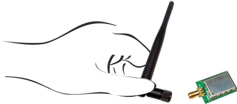
그림 2-2 RP-SMA 다이폴 안테나 설치
