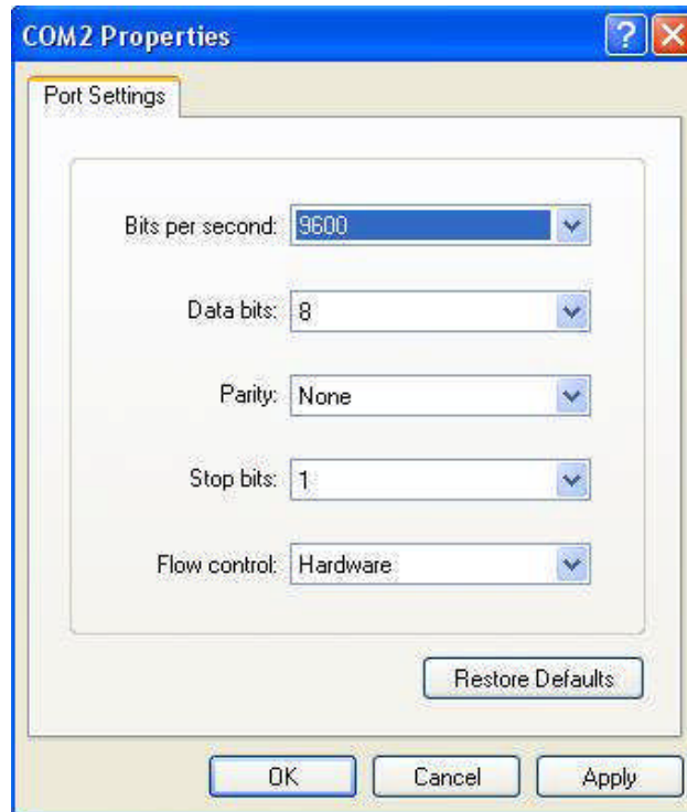
그림 2-9 HyperTerminal 시리얼 포트 설정
