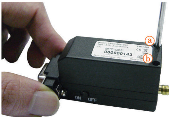
그림 2-7 배터리 팩 고정
