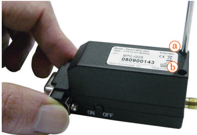
그림 2-7 배터리 팩 고정
