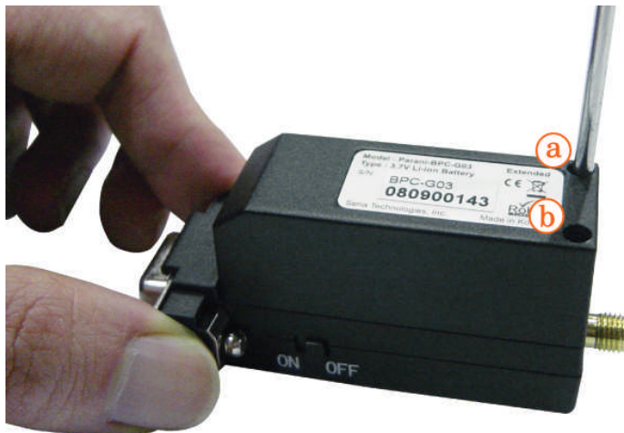
그림 2-7 배터리 팩 고정
