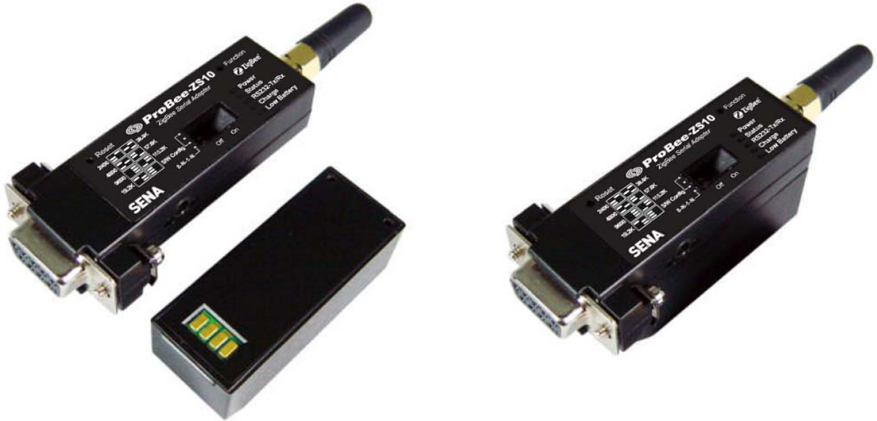
그림 2-4 ZS10에 배터리 팩 연결
