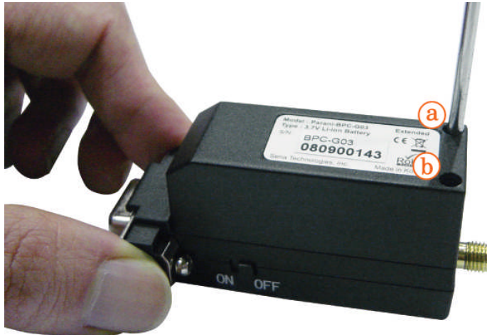
그림 2-7 배터리 팩 고정
