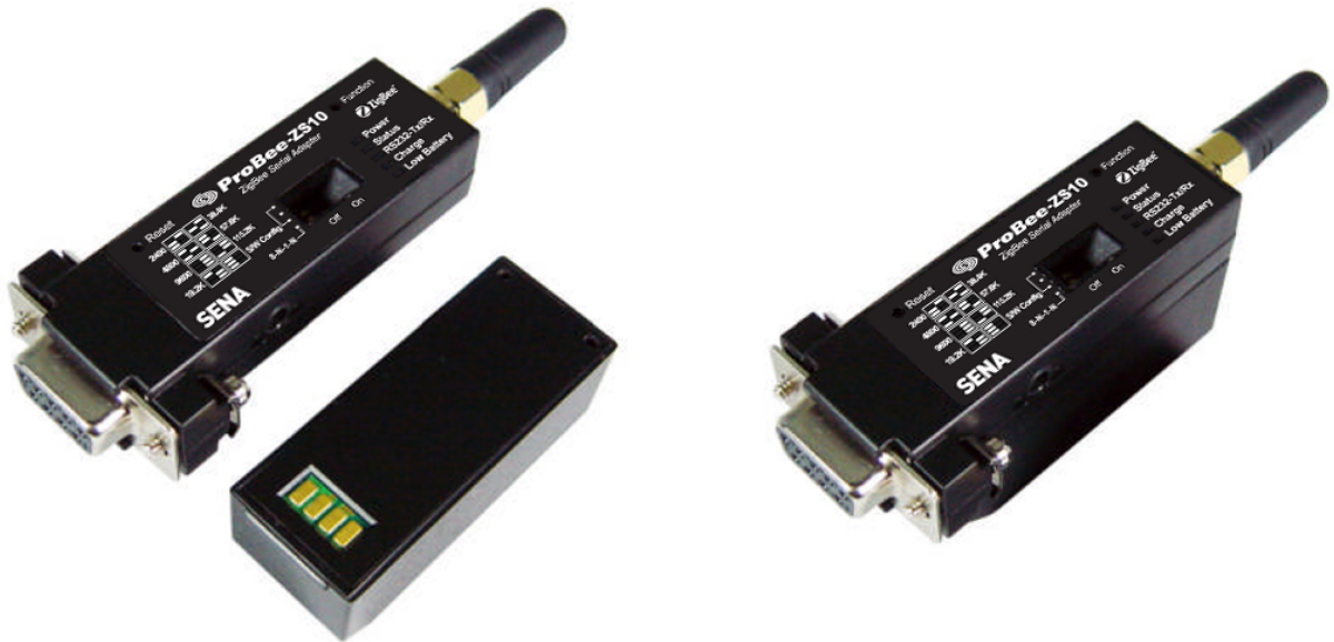
그림 2-4 ZS10에 배터리 팩 연결
