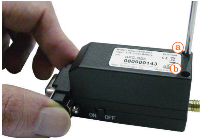
그림 2-7 배터리 팩 고정
