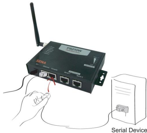
그림 2-66 PSx10W에 시스템 콘솔 케이블을 연결하기
