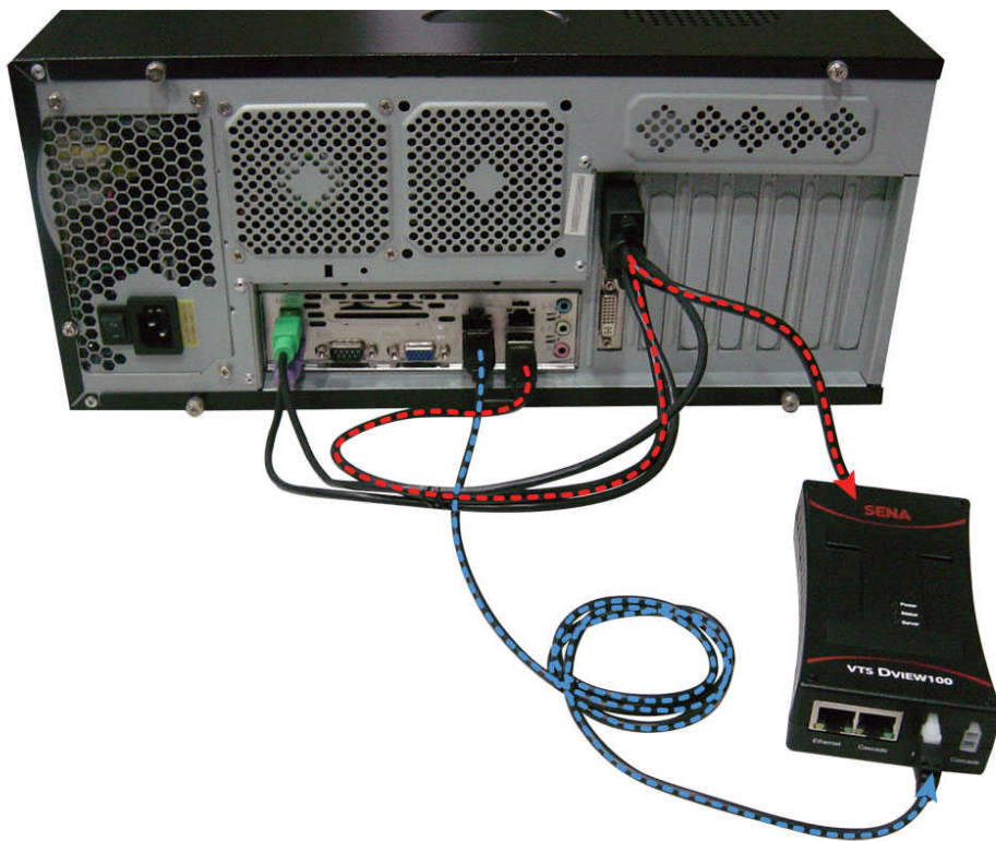
(b) KVM 케이블의 USB와 추가 USB 전원을 동시에 이용한 전원 공급
