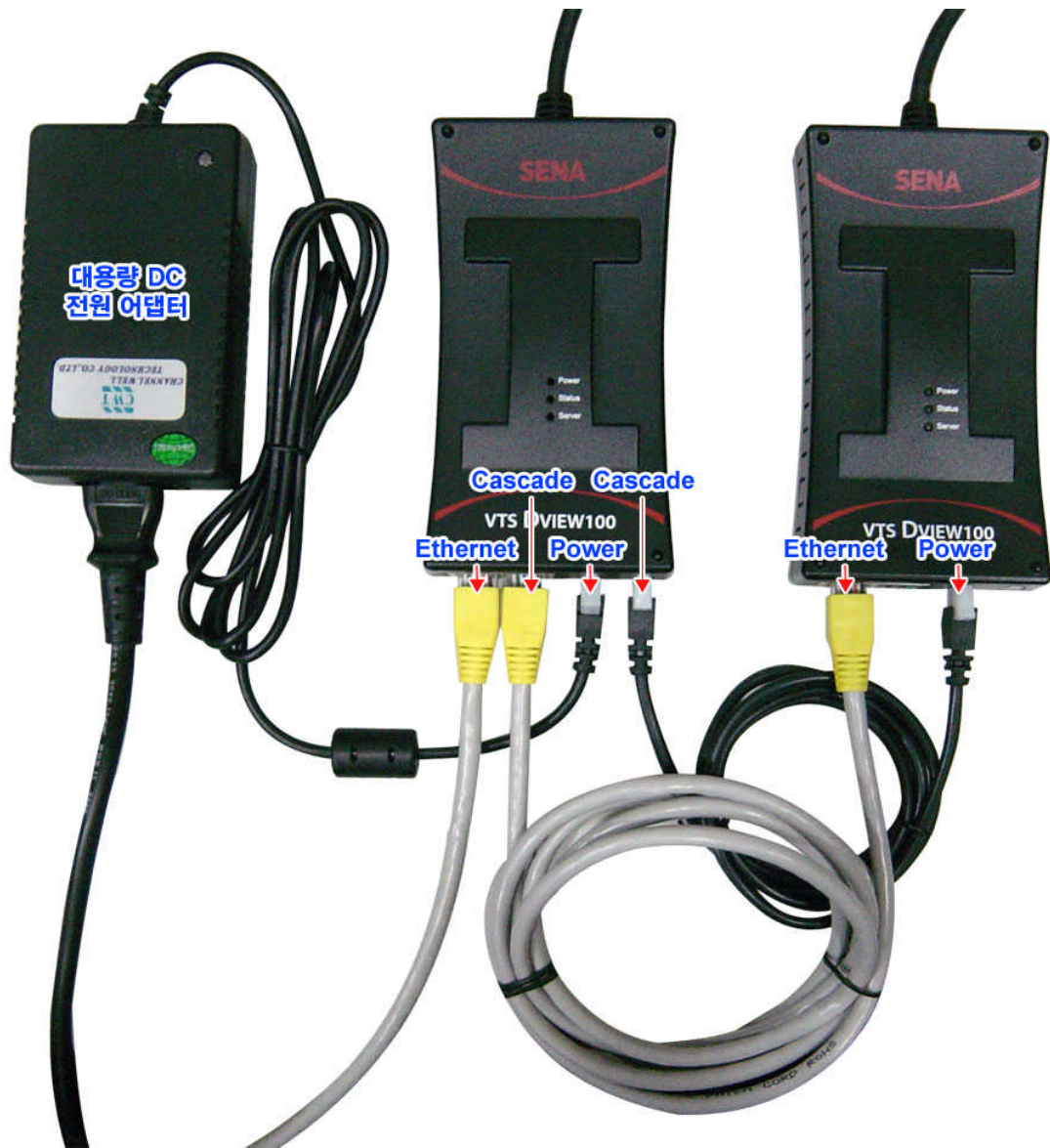
그림 2-5. 여러개의 VTS DView100 연결 (Cascading)
