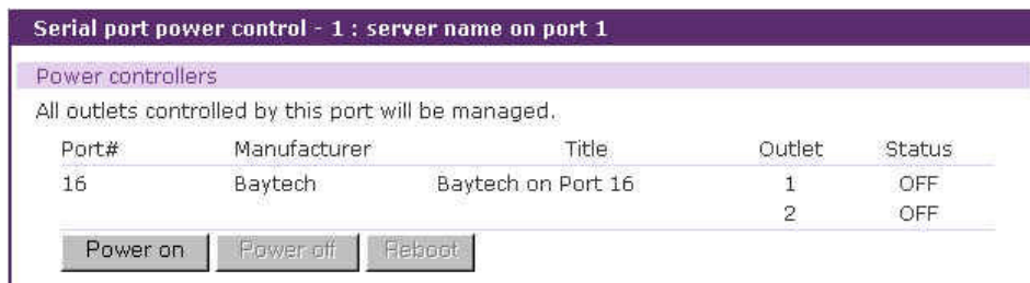
그림 6-13 파워 컨트롤러 유닛 관리 – Serial port power control
