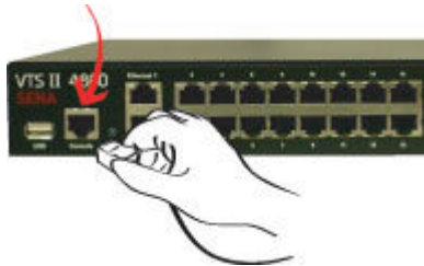
그림 2-6 VTS II에 시스템 콘솔 케이블을 연결하기
