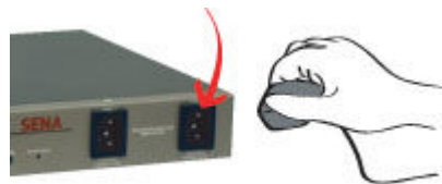
그림 2-3 VTS II에 전원 연결하기
